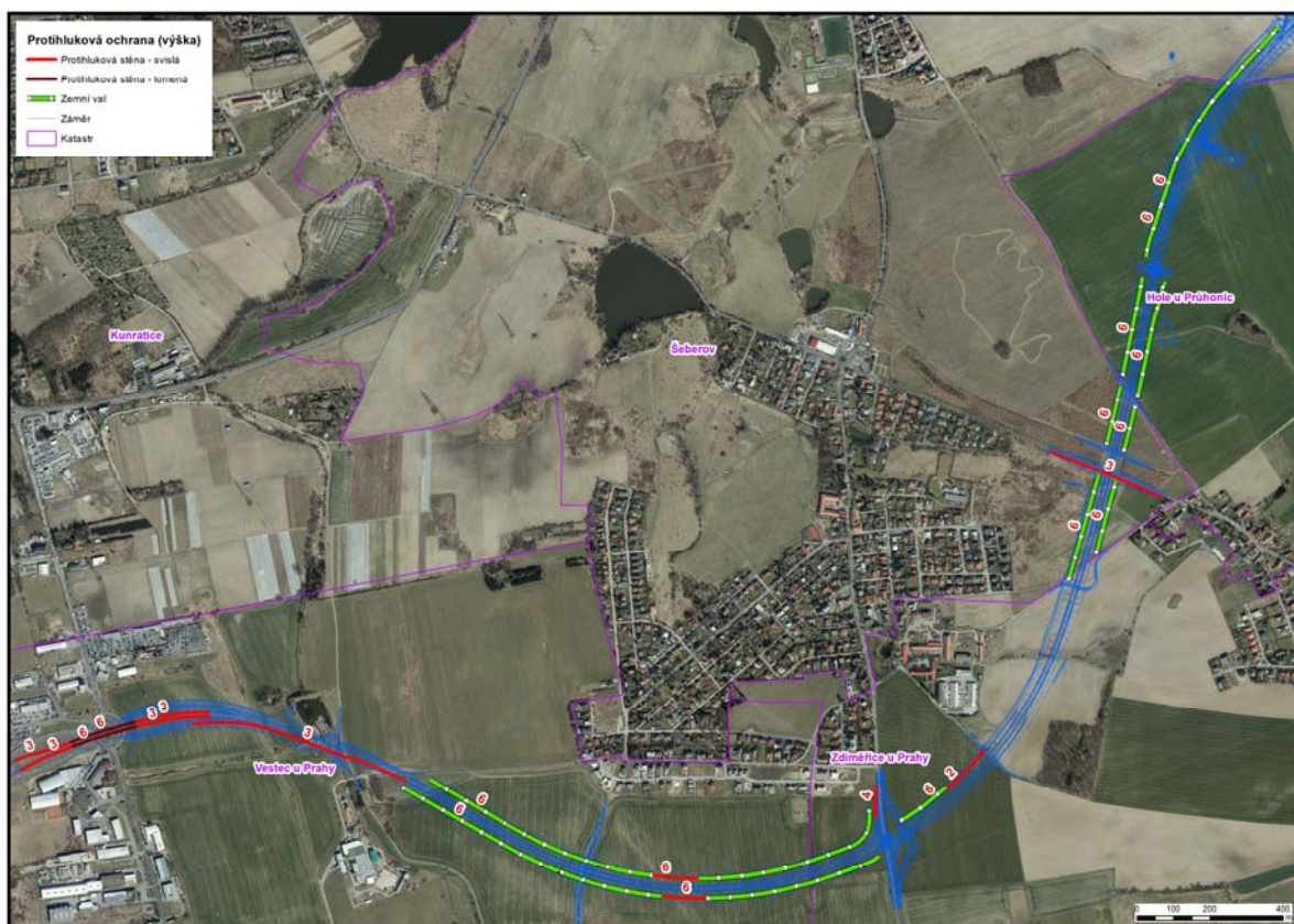
Schéma 10. Navrhovaná protihluková opatření podél Vestecké spojky
